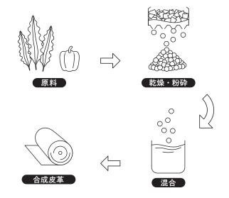
豊田通商グループで発生する食品残渣\* を加工・微粉砕し、合成皮革の原料に 使用しています。
